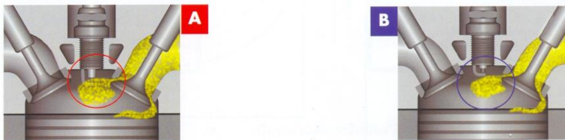
Vliv vysunutí špičky izolátoru na rozšíření tepelného rozsahu
