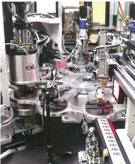
Takto vypadá současná výroba společnosti Brisk. Automatickou linku na výrobu snímačů přináší první záběr. Tunelová pec na vypalování keramiky izolátorů je patrna z druhého obrázku a třetí pak představuje automatickou linku na montáž svíček – vytváření jiskřičtěk.
