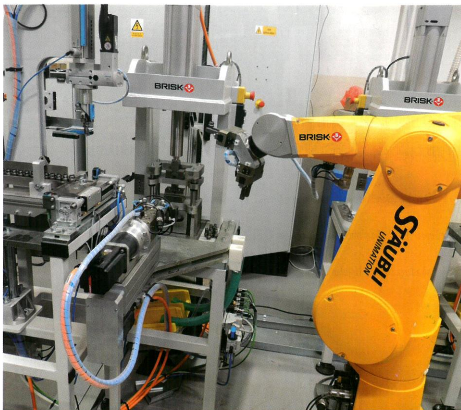
Robotické pracoviště Davep na úpravu kovového pouzdra se specifickým tvarem vnějších elektrod
