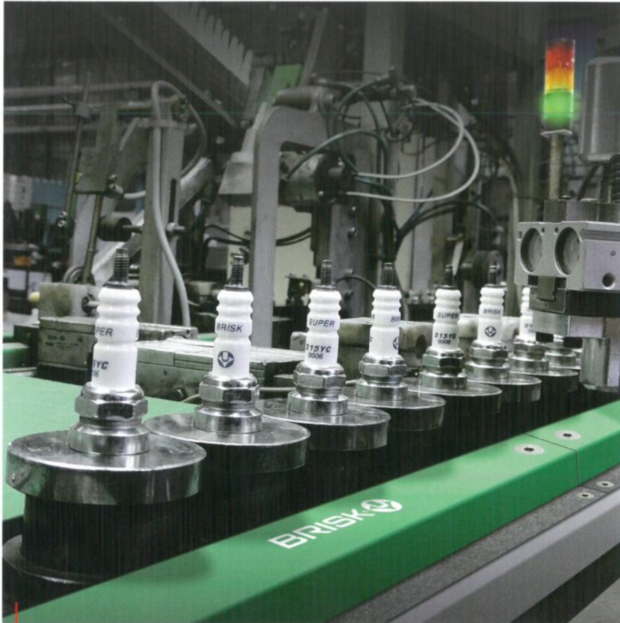
V BRISKu se ročně vyrábí kolem 50 milionů kusů zapalovacích svíček. Foto: BRISK Tábor
