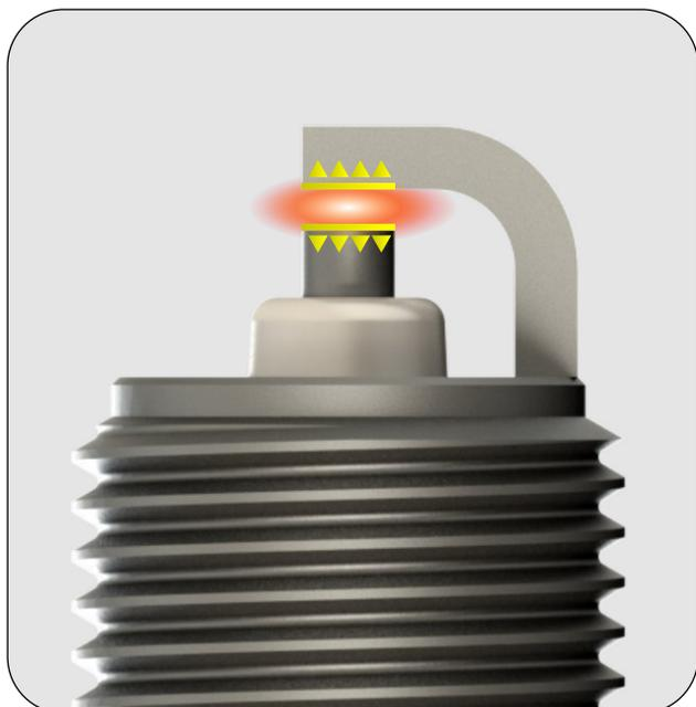
Velké paralelní plochy odčerpávají značné množství tepla do chladných elektrod při studených startech a mohou způsobovat zhasnutí jádra plamene v prvních fázích rozhořívání.
