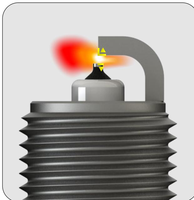
Malé plochy elektrod v oblasti jádra plamene významně omezují množství tepla odčerpaného do chladných elektrod v počáteční fázi rozhořívání plamene. Zároveň nebrání šíření čela plamene do spalovacího prostoru při běžném provozu.
